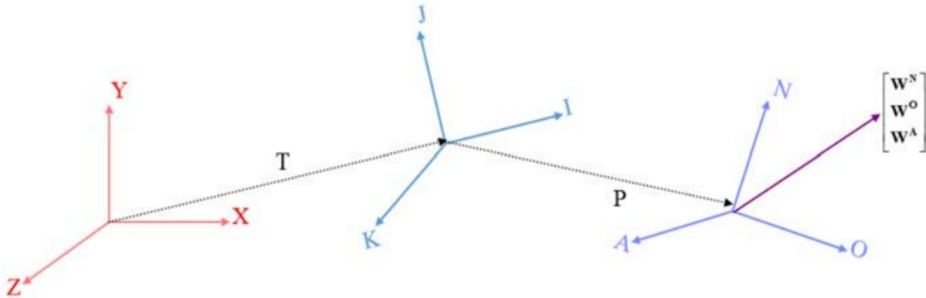
$$\begin{bmatrix} W^X \\ W^Y \\ W^Z \\ 1 \end{bmatrix} = \begin{bmatrix} i_x & j_x & k_x & T_x \\ i_y & j_y & k_y & T_y \\ i_z & j_z & k_z & T_z \\ 0 & 0 & 0 & 1 \end{bmatrix} \begin{bmatrix} n_i & o_i & a_i & P_i \\ n_j & o_j & a_j & P_j \\ n_k & o_k & a_k & P_k \\ 0 & 0 & 0 & 1 \end{bmatrix} \begin{bmatrix} W^N \\ W^O \\ W^A \\ 1 \end{bmatrix}$$
